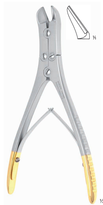
116 91 0005 17,0 cm pro tvrdý drát do průměru 1,5 mm for hard wires up to diameter 1,5 mm
